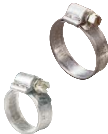
Šroubová hadicová spona se šnekovým závitom v souladu s SS 2298, šířka pásku 9 a 12 mm, materiál aluzinc.
