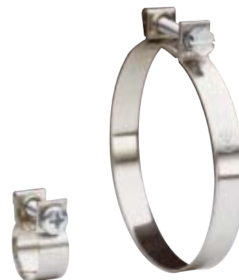
Šroubové hadicové spony s čelistí podle DIN 3017, šířka pásku 9 mm. 5 a 12 mm na zakázku.
